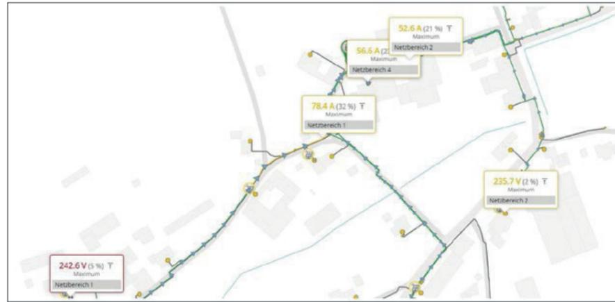
Bild 2. Über GridCal gelingt das Niederspannungsmonitoring in Echtzeit bereits auf der Feldebene.
