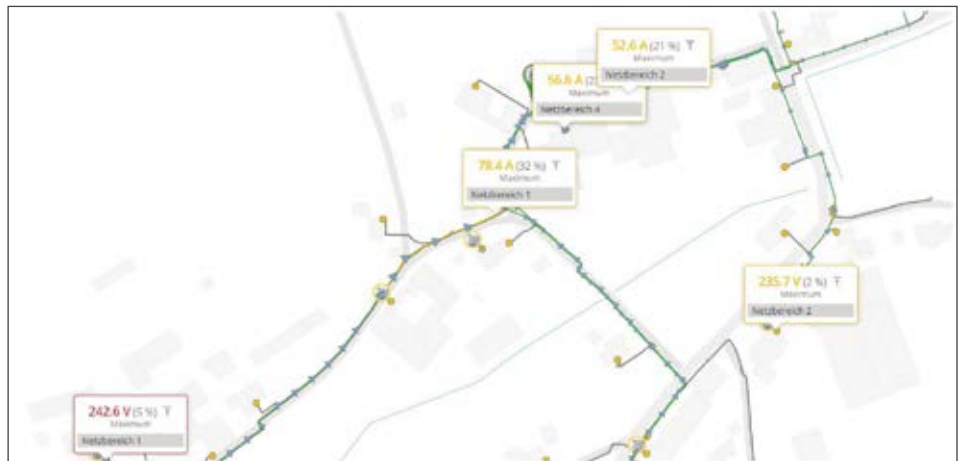
Bild 2. Über GridCal gelingt das Niederspannungsmonitoring in Echtzeit bereits auf der Feldebene.
