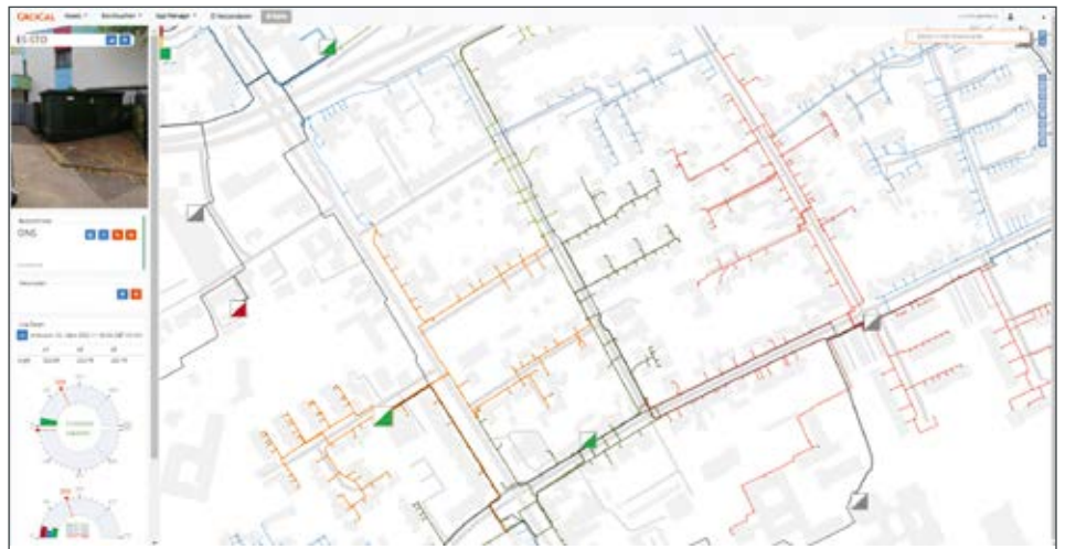
Bild 3. Durch die Einbindung von Georeferenzdaten erstellt der GridCal Operator einen digitalen Zwilling des Verteilnetzes.
