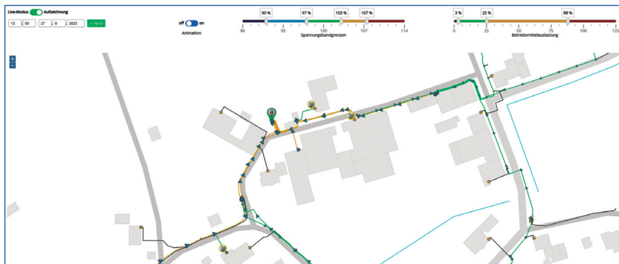
Mittels der GridCal-Nodes lassen sich noch in den Netzstationen Simulationen des Ortsnetzes in Echtzeit durchführen, um so etwa Netzengpässe schnellstmöglich zu erkennen. (Foto: PSInsight GmbH)
